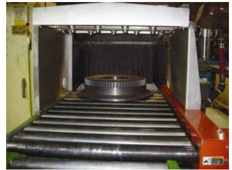
Alcuni amplificatori cod 6041 puliscono e raffreddano pezzi in ghisa dopo la lavorazione
