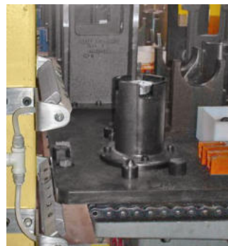
Pulizia pallet porta pezzi prima del carico del pezzo da lavorare
