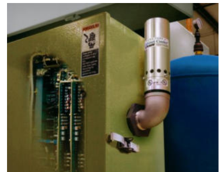
Condizionatore Exair 4630 installato sulla parete dell'armadio
