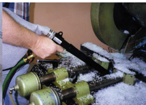
Kit Collection System 6192 aspira polvere di plastica
