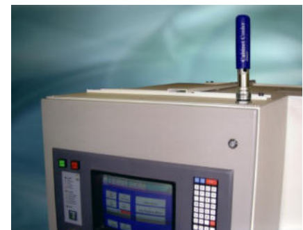
Condizionatore Exair 4015 su pulsantiera di comando CNC
