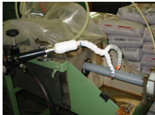
Raffreddamento di tubi dopo l'estrusione
