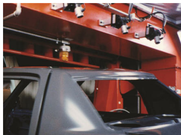
Gen4 Ion Air Cannon rimuove cariche e soffia via polvere da carrozzerie di auto prima della verniciatura
