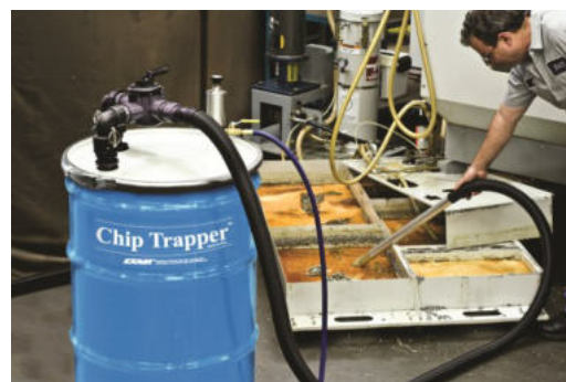
Trucioli ed emulsione nella vasca della macchina
