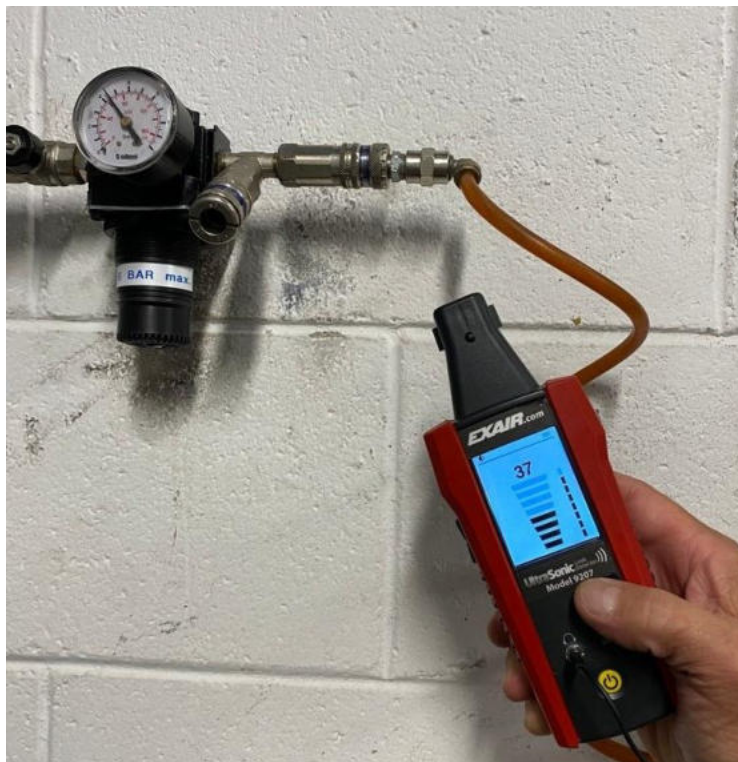
Verifica perdite da raccordi pneumatici
