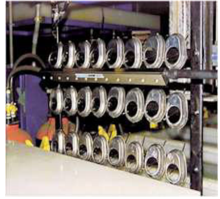
Asciugatura pezzi dopo il lavaggio e sgrassaggio
