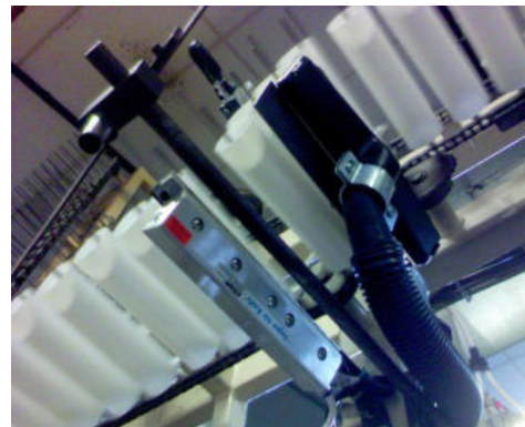
Gen 4 Super Ion Air Knife codice 112009 neutralizza la carica e toglie polvere da tubetti in materiale plastico
