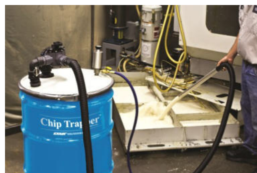
Emulsione filtrata da Chip Trapper
