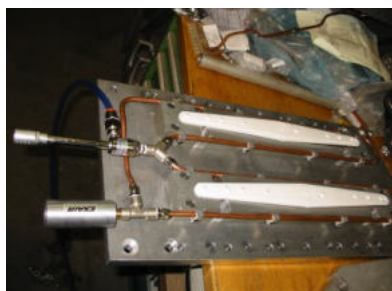
Raffreddamento dopo saldatura ultrasuoni eliche lavastoviglie
