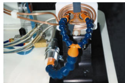
Raffreddamento trafilatura per produrre tubetti uso medicale
