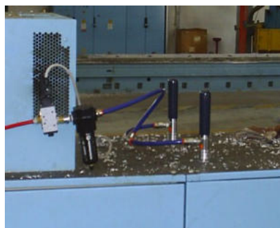
Condizionatori Exair 4030 su quadro elettrico di un'alesatrice
