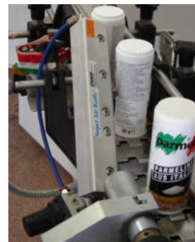
Pulizia contenitori per alimenti prima dell'etichettatura
