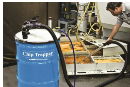
Trucioli ed emulsione nella vasca della macchina
