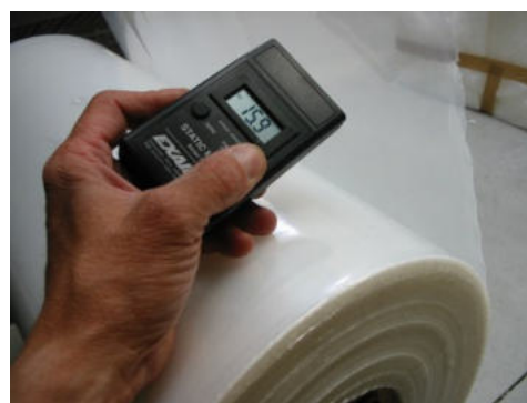
Rilevazione di cariche elettrostatiche su film termoretraibile
