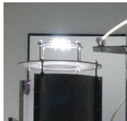
Raffreddamento lampada e filtro per simulatore solare
