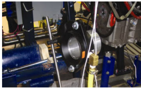
Raffreddamento di motori automobilistici durante la prova al banco dinamometrico
