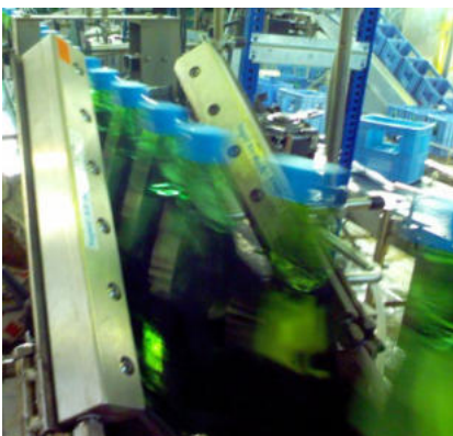
Asciugatura bottiglie in vetro prima dell'etichettatura
