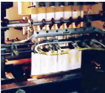
Standard air Knife apre sacchetti per confezionamento
