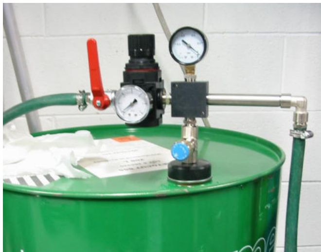
Il manometro pressione acqua ed il vuotometro, quest'ultimo se indica un valore superiore a 0,5/0,6 BAR il miscelatore sta funzionamento
