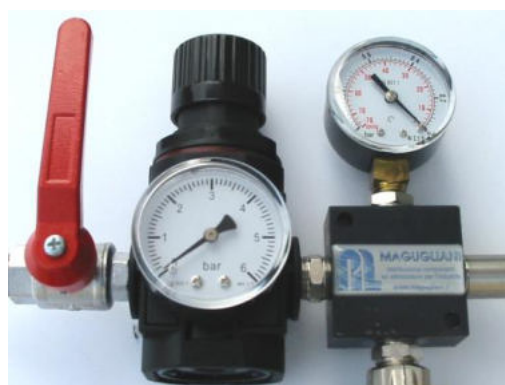
Il manometro pressione acqua ed il vuotometro, quest'ultimo se indica un valore superiore a 0,5/0,6 BAR il miscelatore sta funzionamento
