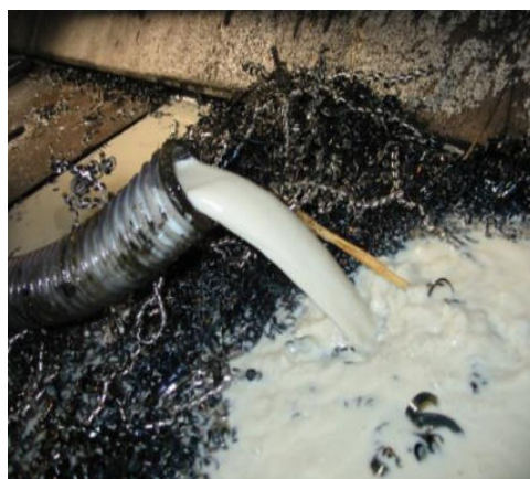
Emulsione trattata in uscita dal depuratore-disoleatore MIXI
