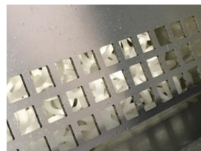
Anelli di separazione olio-emulsione
