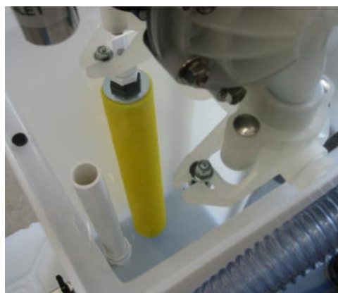
Vasca separatrice con l'elemento di separazione olio brevettato
