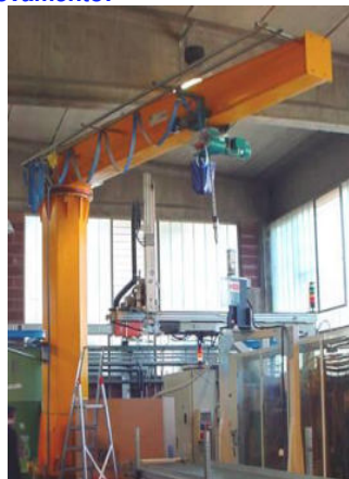
Gru a colonna in trave motorizzata
