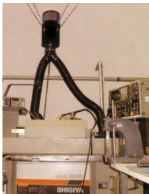
Filtro aspira da due macchine
