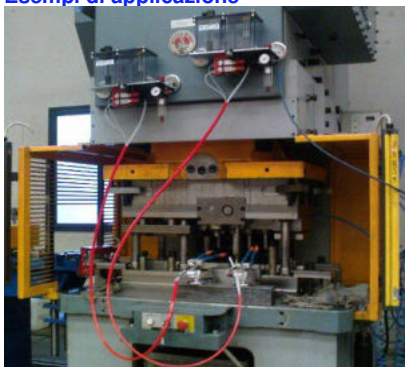
Lubrificazione e raffreddamento di stampo per trancitura
