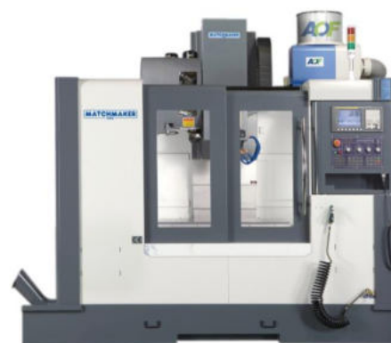
Filtro AIR-O-FILTER installato su macchina utensile
