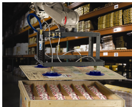
Sollevatore dotato di generatore In-Line E-Vac e quattro ventose Exair
