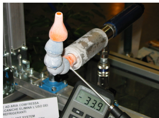
Raffreddatore Exair durante un test per verificare la temperatura in uscita
