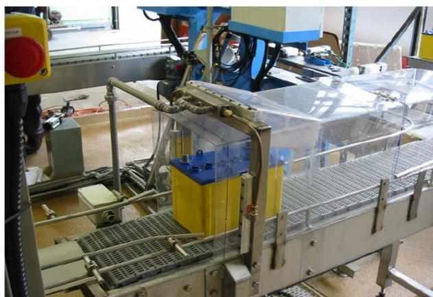
Asciugatura di batterie per autotrazione
