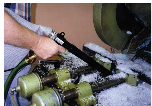
Kit Collection System 6192 aspira polvere di plastica
