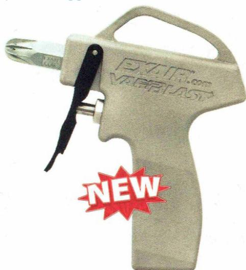
Pistole compatte e leggere, sono dotate di grilletto in grado di variare il flusso in funzione della forza ad esso applicata. Possono montare tutti gli ugelli Exair con attacco da 1/8" anche con prolunga di lunghezza fino a 1830 mm. Il corpo costruito in alluminio offre grande robustezza. Gli ugelli sono disponibili in alluminio o acciaio inox AISI 316 o AISI 303 ed in materiale termoplastico PEEK. Dimensioni, rumorosità e consumi contenuti, forza di soffiaggio regolabile.
