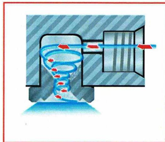
Con gli ugelli per liquidi "FullStream" Exair, il fluido da espellere entra nel corpo dell'ugello in modo tangenziale, si crea così un vortice di liquido e per impatto sulle superfici dell'ugello si creano le goccioline attraverso la rottura della tensione molecolare del liquido, questo garantisce una buona distribuzione in uscita a cono pieno e ben distribuito.
