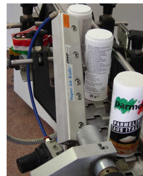
Pulizia contenitori per alimenti prima dell'etichettatura
