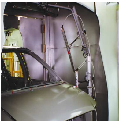
Pulizia carrozzerie di automobili prima della verniciatura
