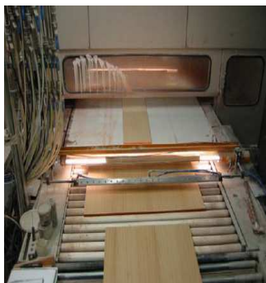
Pulizia pannelli di legno prima della verniciatura
