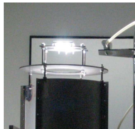
Raffreddamento lampada e filtro per simulatore solare
