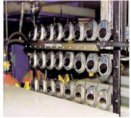
Asciugatura pezzi dopo il lavaggio e sgrassaggio
