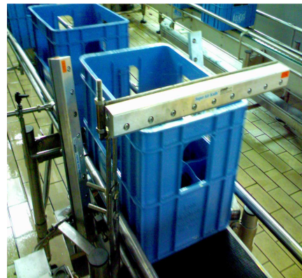
Asciugatura cassette di plastica per acqua minerale
