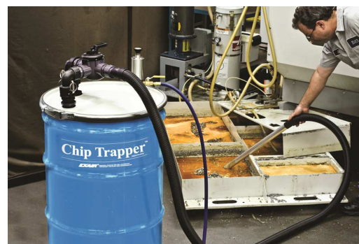
Trucioli ed emulsione nella vasca della macchina
