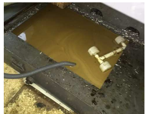
Gruppo pescante inserito in vasca prima della depurazione
