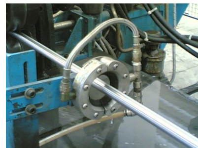
Super Air Wipe asciuga un tubo dopo la laminazione
