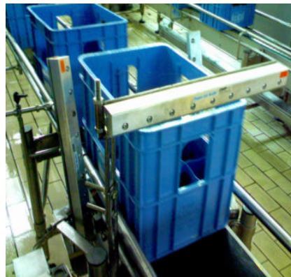
Asciugatura cassette di plastica per acqua minerale
