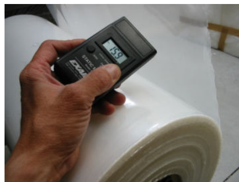
Rilevazione di cariche elettrostatiche su film termoretraibile
