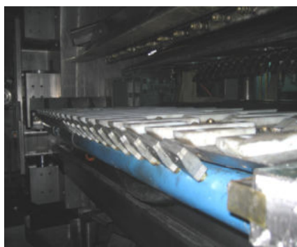
Ugelli piatti 2" Flat Air Nozzles 1122 generano un flusso appiattito d'aria
