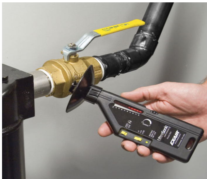
Verifica perdite da raccordi pneumatici
