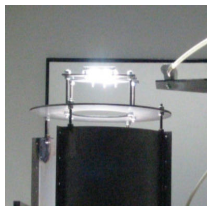
Raffreddamento lampada e filtro per simulatore solare
