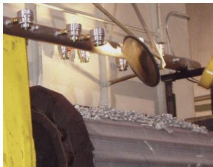
Amplificatori cod 6042 asciugano pezzi dopo il lavaggio
