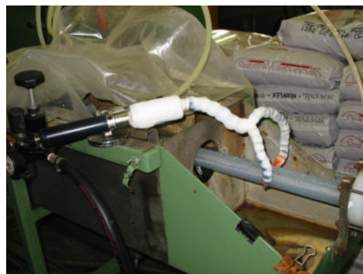
Raffreddamento di tubi dopo l'estrusione
