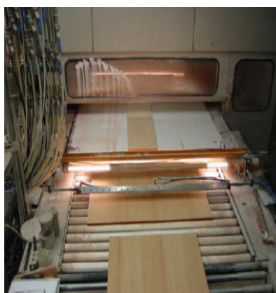
Pulizia pannelli di legno prima della verniciatura
