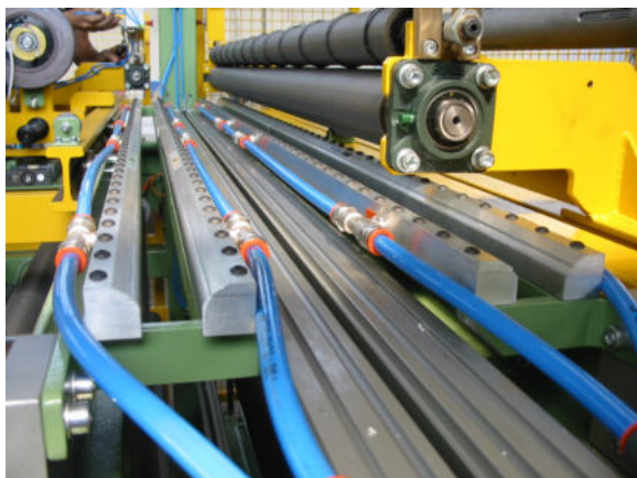
Full Flow Air Knife portano il film plastico nella corretta direzione
