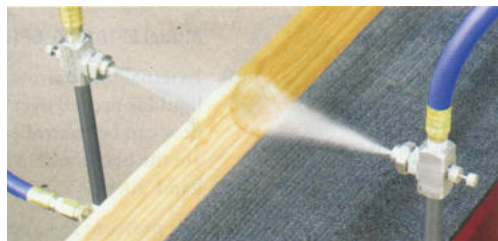
Due atomizzatori modello ER1020SS sono utilizzati per impregnare assi di legno
