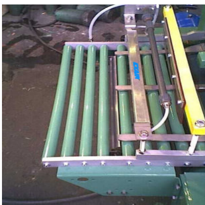
Asciugatura piastrelle in uscita dalla macchina
