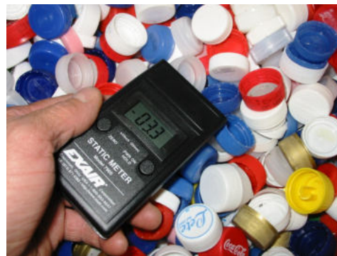
Rilevazione di cariche elettrostatiche su contenitore di tappi PET
