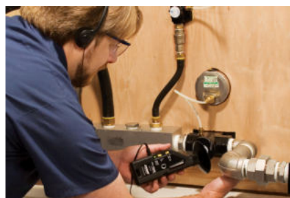
Verifica presenza perdite da raccordi pneumatici
