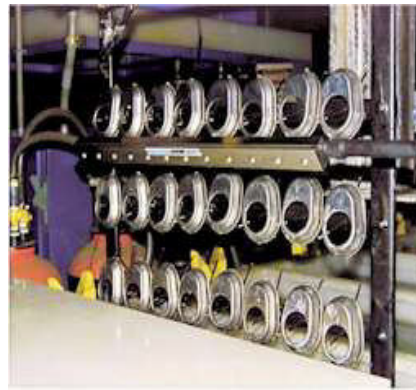
Asciugatura pezzi dopo il lavaggio e sgrassaggio
