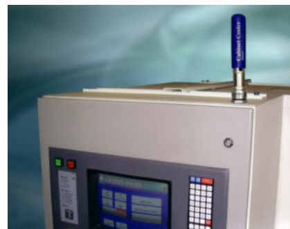
Condizionatore Exair 4015 su pulsantiera di comando CNC
