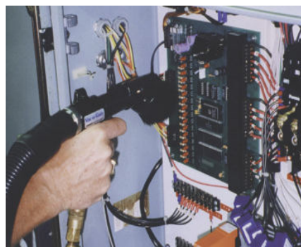
Vac-U-Gun con spazzola per aspirare polvere
