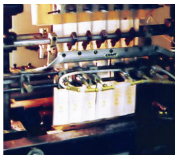
Standard air Knife apre sacchetti per confezionamento
