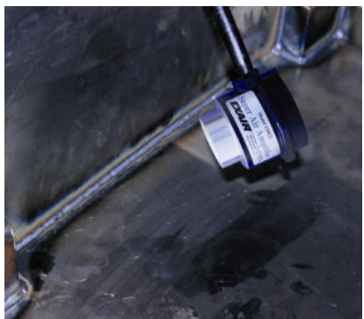
Raffreddamento di cordoni di saldatura
