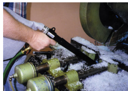
Kit Collection System 6192 aspira polvere di plastica
