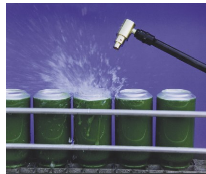
Getto ad alta velocità d'aria Air Jet 6013 utilizzato per asciugare lattine di alluminio
