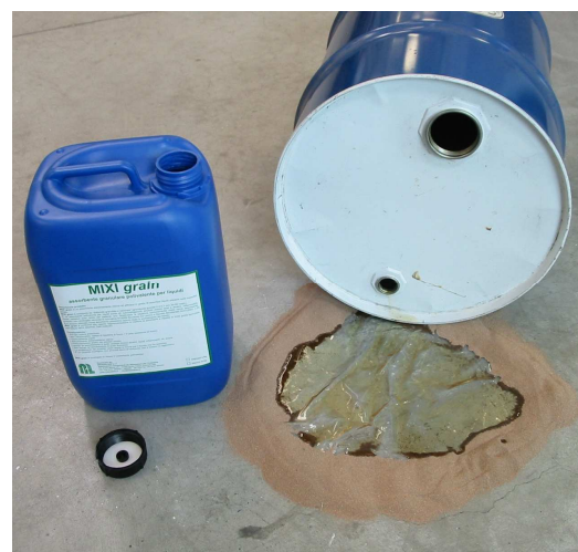
Barriera per evitare la propagazione del liquido
