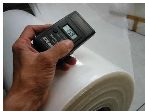
Rilevazione di cariche elettrostatiche su film termoretraibile
