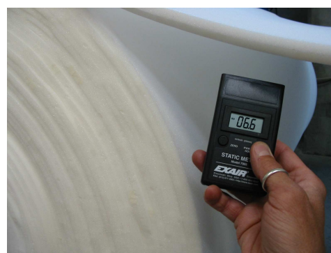
Rilevazione di cariche elettrostatiche su poliuretano espanso flessibile
