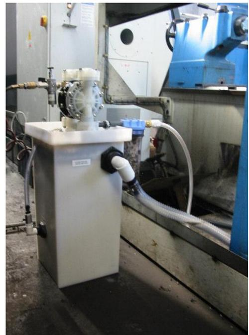
**Depuratore-disoleatore MIXI in funzione**
