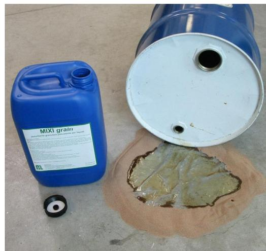
Barriera per evitare la propagazione del liquido
