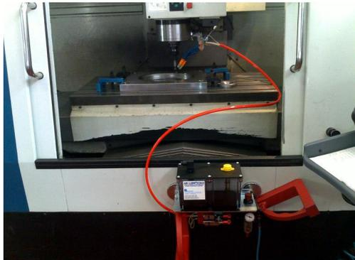
Raffreddamento e lubrificazione durante fresatura
