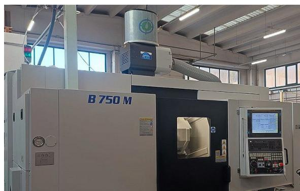
Filtro AIR-O-FILTER installato su macchina utensile
