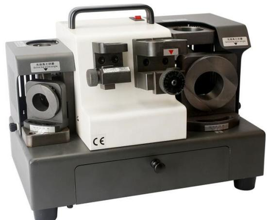
Modello Z32 dotata di 2 mole una per punte da d. 3 a 13 mm e l'altra per punte da d. 13 a 32 mm
