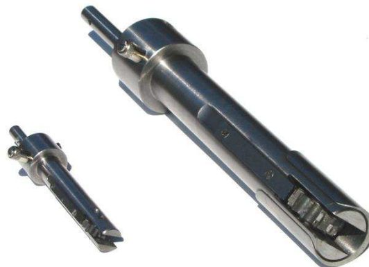
Mandrini Slotty pronti per l'uso: a sinistra per foro 15 mm cava 5 mm a destra con bussola diam. 36 mm per foro diam. 36 mm cava 10 mm
