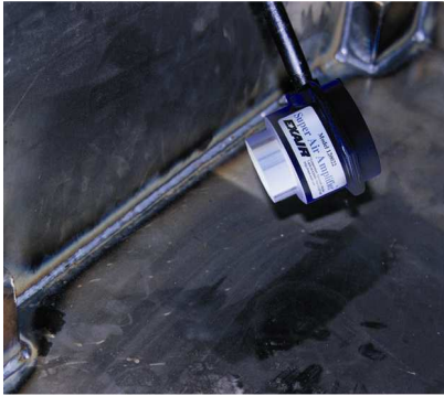
Raffreddamento di cordoni di saldatura
