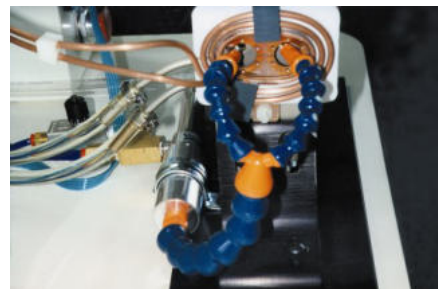
Raffreddamento trafilatura per produrre tubetti uso medicale
