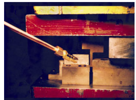
Ugello Safety Air Nozzle 1002 diminuisce il rimbalzo dei trucioli verso l'operatore
