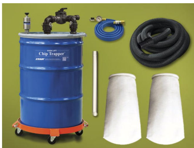
Modello 6190 High Lift Chip Trapper pompa reversibile con sistema di separazione solidi-liquidi comprende: 2 filtri a manica riutilizzabili, fusto da 200 litri, carrello porta fusto, 6 metri tubo aria compressa
