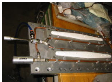
Raffreddamento dopo saldatura ultrasuoni eliche lavastoviglie
