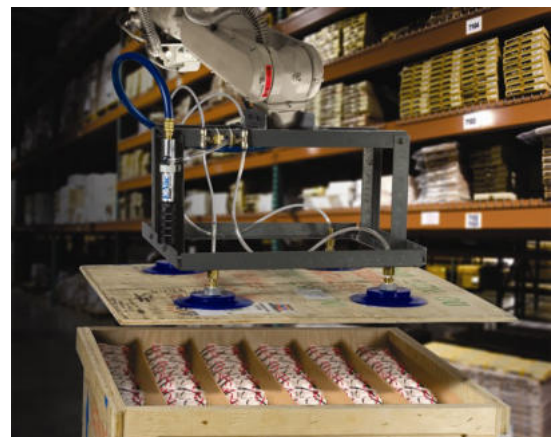
Sollevatore dotato di generatore In-Line E-Vac e quattro ventose Exair
