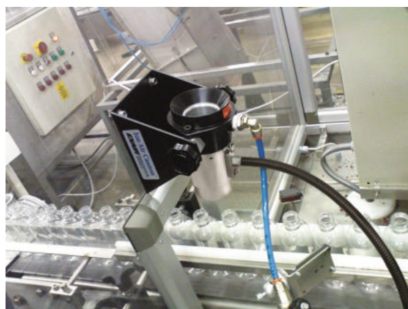
Gen4 Ion Air Cannon rimuove cariche da bottiglie di plastica
