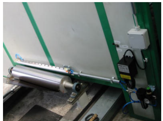
Gen4 Standard Ion Air Knife neutralizza cariche e pulisce film di lamiera metallica
