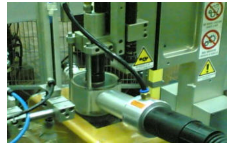
Aspirazione trucioli di plastica durante l'asportazione di bave
