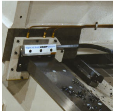
Rimozione trucioli da guide di scorrimento di macchina utensile
