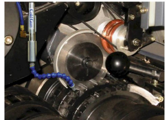
Taglio alta velocità: Cold Gun raffredda lama circolare per taglio filtri sigarette (10.000 tagli/minuto)
