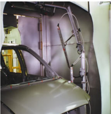
Pulizia carrozzerie di automobili prima della verniciatura
