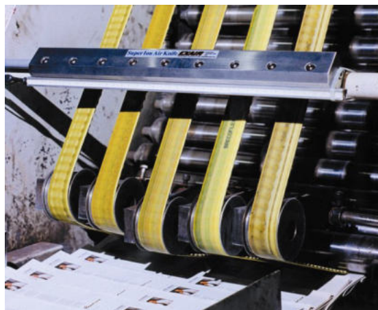
Gen4 Super Ion Air Knife 112018 neutralizza la carica da fogli di carta
