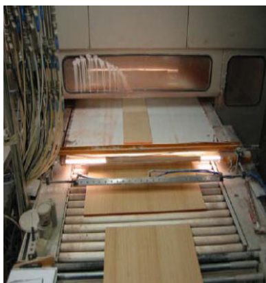
Pulizia pannelli di legno prima della verniciatura
