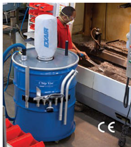
Premium Chip Vac da 400 litri aspira residui di lavorazione
