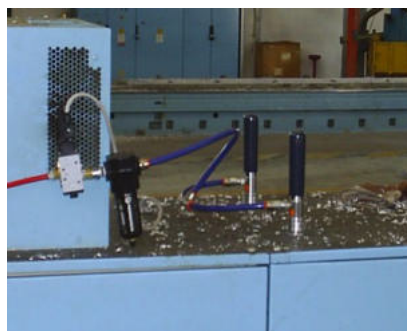
Condizionatori Exair 4030 su quadro elettrico di un'alesatrice
