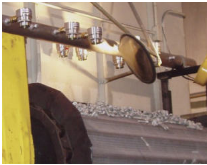
Amplificatori cod 6042 asciugano pezzi dopo il lavaggio
