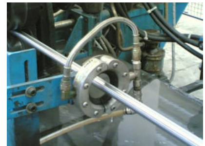
Super Air Wipe asciuga un tubo dopo la laminazione
