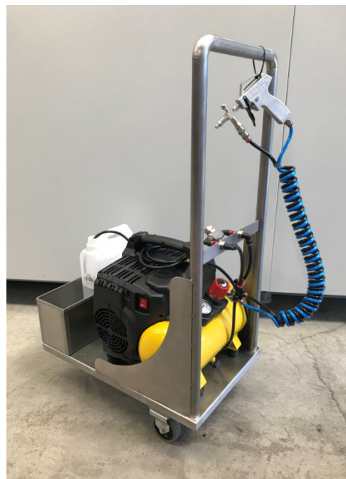
SANIMAG2020miniCP stazione mobile per atomizzare liquidi sanificanti disinfettanti con pistola atomizzatrice per superfici
