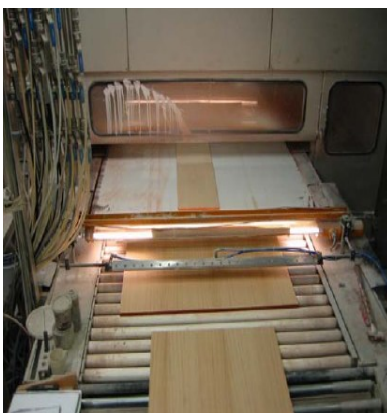
Pulizia pannelli di legno prima della verniciatura
