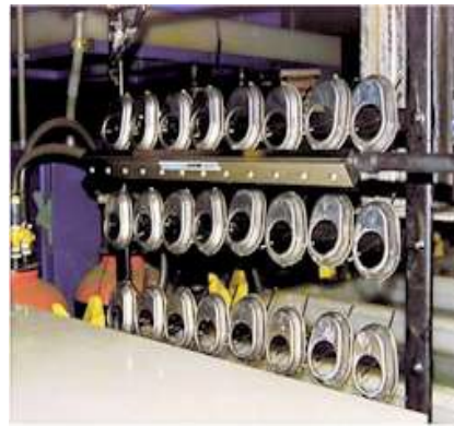
Asciugatura pezzi dopo il lavaggio e sgrassaggio
