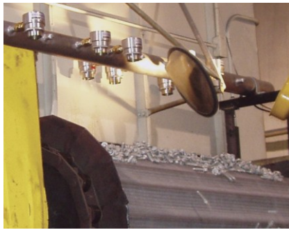
Amplificatori cod 6042 asciugano pezzi dopo il lavaggio
