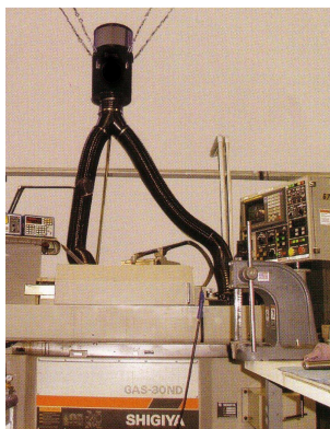
Filtro aspira da due macchine
