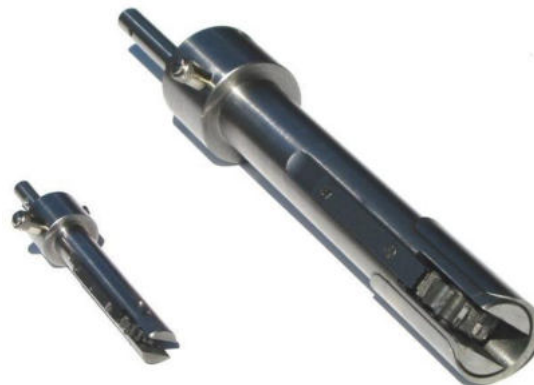
Mandrini Slotty pronti per l'uso: a sinistra per foro 15 mm cava 5 mm a destra con bussola diam. 36 mm per foro diam. 36 mm cava 10 mm
