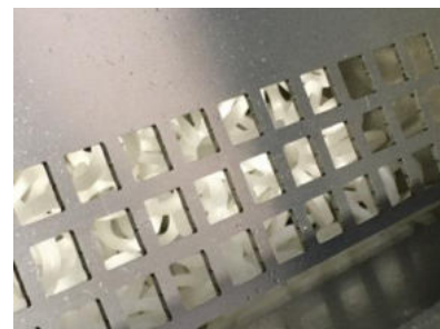
Anelli di separazione olio-emulsione
