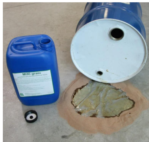
Barriera per evitare la propagazione del liquido
