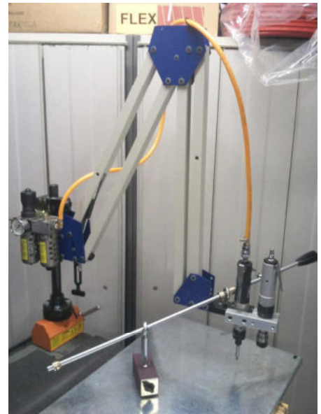
Braccio parallelo con sistema di moltiplicazione spinta assiale
