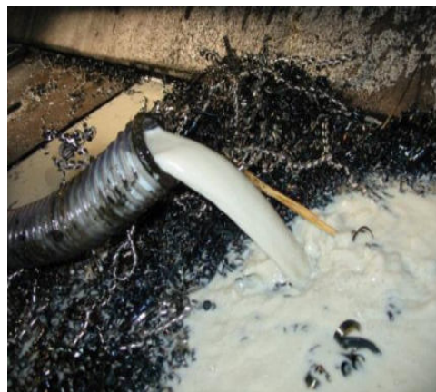
Emulsione trattata in uscita dal depuratore-disoleatore MIXI
