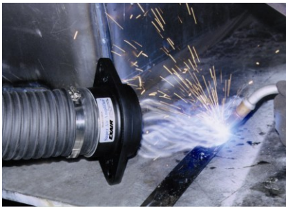
Aspirazione di fumi e gas prodotti durante la saldatura di pezzi
