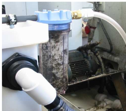
Filtro primario rimozione particelle solide con cartuccia in rete inox riutilizzabile
