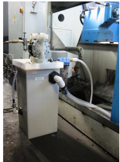
Depuratore-disoleatore MIXI in funzione
