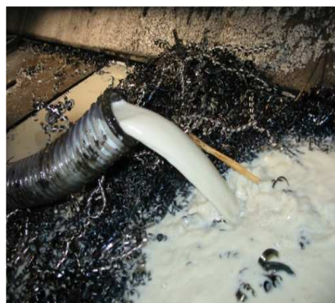
Emulsione trattata in uscita dal depuratore-disoleatore MIXI
