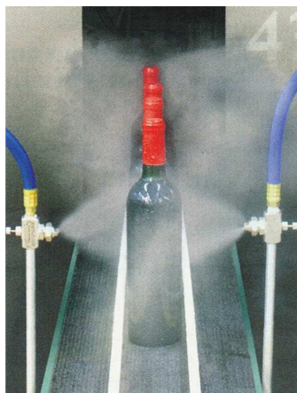
Due atomizzatori modello EB1040SS sono utilizzati per risciacquare bottiglie di vino
