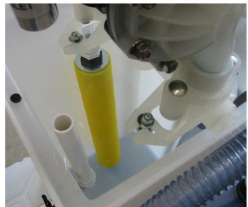
Vasca separatrice con l'elemento di separazione olio brevettato
