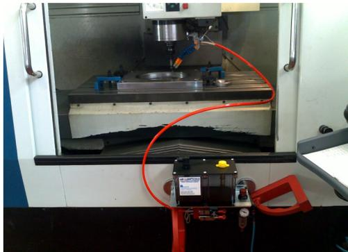
Raffreddamento e lubrificazione durante fresatura
