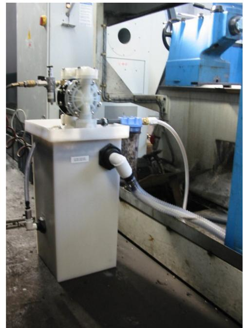
**Depuratore-disoleatore MIXI in funzione**
