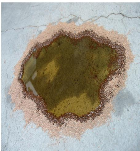
MIXI grain fa da barriera alla propagazione dell'olio versato
