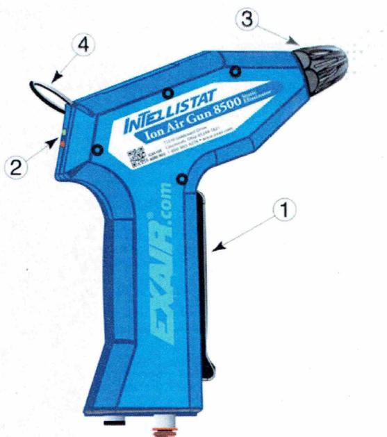
Premendo il lungo grilletto (1) si attivano l'emissione di ioni e aria compressa. Il corretto funzionamento è segnalato dall'accensione molto luminosa del led verde mentre il led rosso resta appena luminoso. Quando il led verde si spegne e resta acceso solo il led rosso molto luminoso l'ago emettitore necessita di pulizia e/o sostituzione oppure è bagnato dalla condensa dell'aria compressa.
