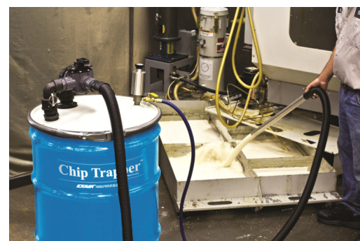
Emulsione filtrata da Chip Trapper
