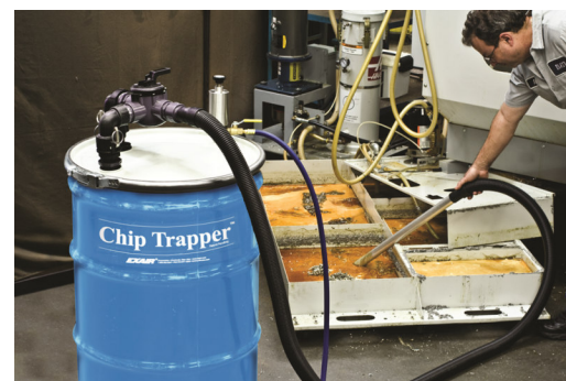
Trucioli ed emulsione nella vasca della macchina
