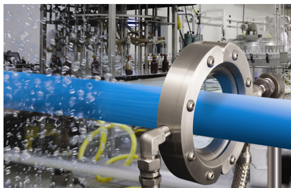
Super Air Wipe in acciaio inox rimuove l'acqua da un tubo estruso dopo la vasca di raffreddamento
