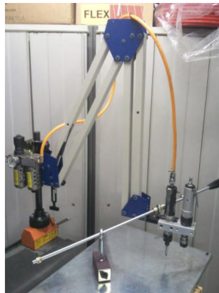
Braccio parallelo con sistema di moltiplicazione spinta assiale
