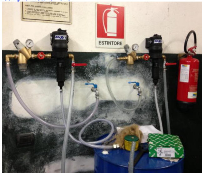
Miscelatori per la preparazione di emulsione lubrorefrigerante per macchine utensili
