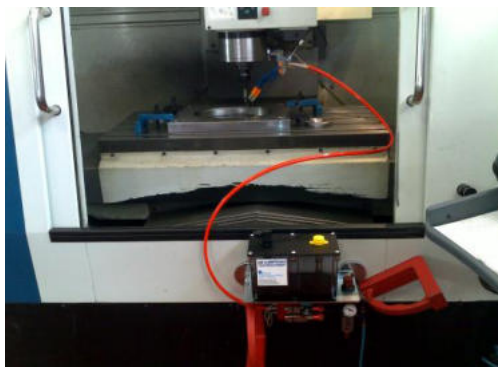
Raffreddamento e lubrificazione durante fresatura
