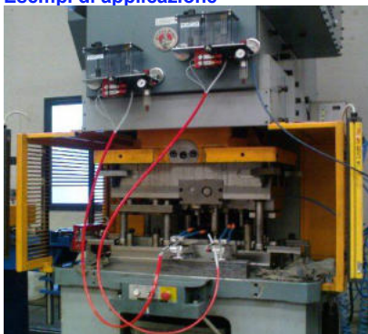
Lubrificazione e raffreddamento di stampo per tranciatura
