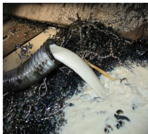
Emulsione trattata in uscita dal depuratore-disoleatore MIXI
