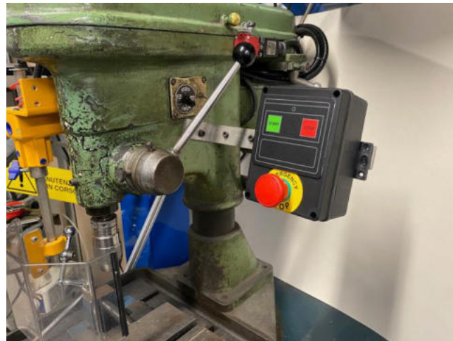
Apparecchiatura elettrica per motori fino a 10 hp
