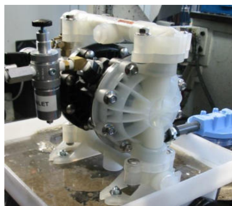
Pompa pneumatica a doppio effetto
