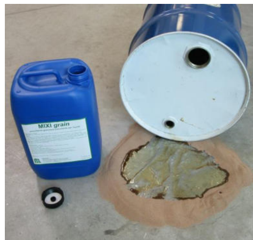
Barriera per evitare la propagazione del liquido
