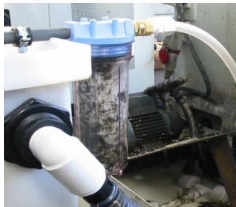
Filtro primario rimozione particelle solide con cartuccia in rete inox riutilizzabile
