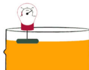
Installazione indicatore di livello
