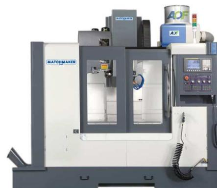
Filtro AIR-O-FILTER installato su macchina utensile
