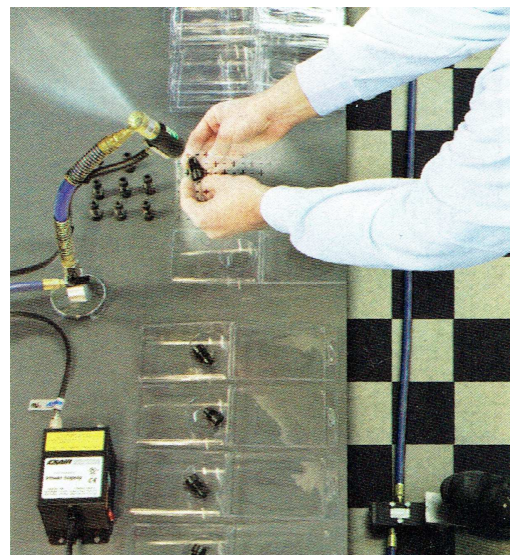
Stay Set Gen4 Ion Air Jet codice 8194-9362 rimuove la polvere da componenti prima del confezionamento in blister
