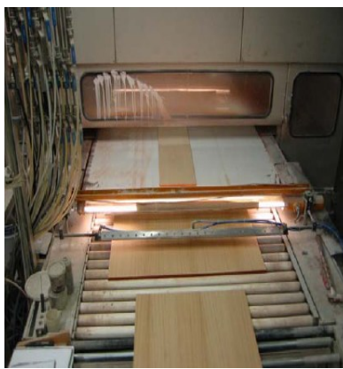
Pulizia pannelli di legno prima della verniciatura
