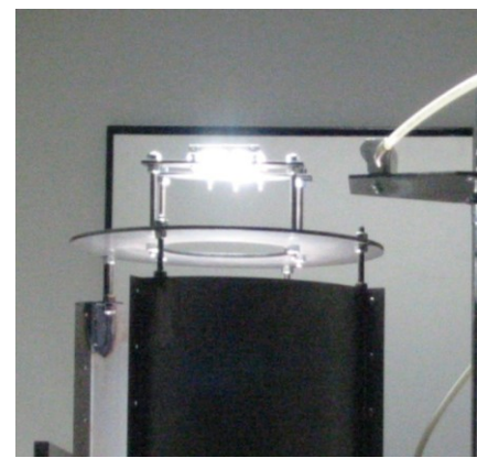
Raffreddamento lampada e filtro per simulatore solare
