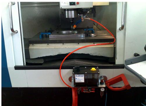
Raffreddamento e lubrificazione durante fresatura
