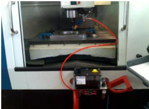
Raffreddamento e lubrificazione durante fresatura
