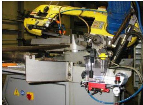
Raffreddamento e lubrificazione segatrice a nastro
