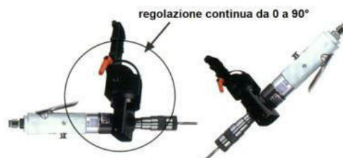
Supporto porta utensili angolare fino a 90° codice AT12-90
