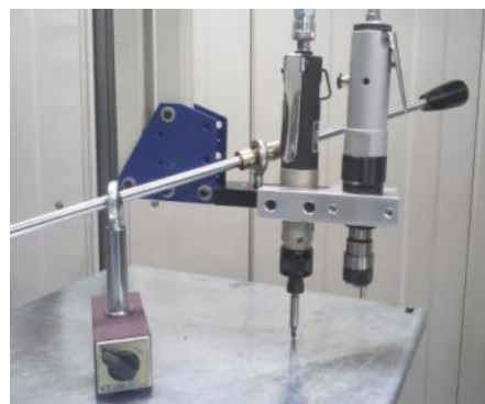
Primo piano del sistema di moltiplicazione spinta assiale con installato maschiatore ed avvitatore
