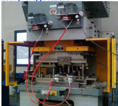
Lubrificazione e raffreddamento di stampo per tranciatura
