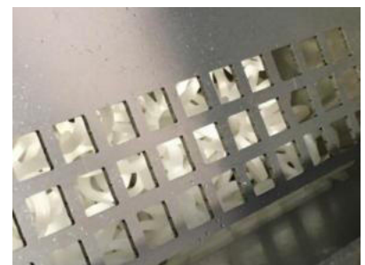
Anelli di separazione olio-emulsione
