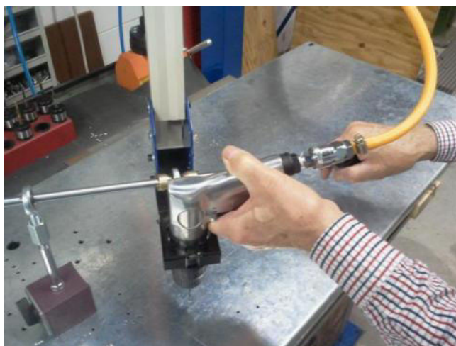
Foratura utilizzando il sistema di moltiplicazione spinta assiale
