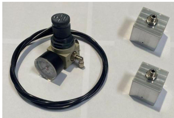
MIXI O 2 X2 sistema di ossigenazione emulsioni con 2 blocchetti ossigenatori, regolatore di pressione, manometro 0-4 BAR, magnete al neodimio, 4 metri tubo aria compressa e raccordi
