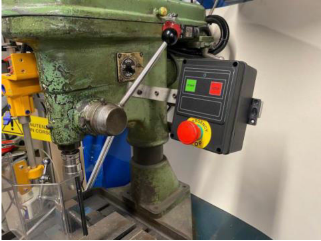
Apparecchiatura elettrica per motori fino a 10 hp
