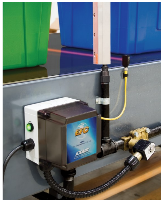
Controllo Elettronico di Flusso EFC installato su impianto
