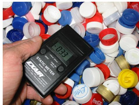
Rilevazione di cariche elettrostatiche su contenitore di tappi PET
