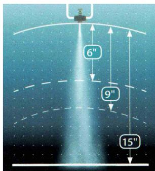
La quantità di liquido atomizzata da questi ugelli dipende dalla regolazione della valvola a spillo e dalla pressione aria compressa
