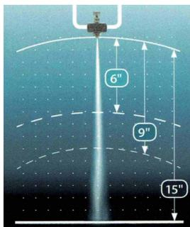
La quantità di liquido atomizzata è facilmente regolabile tramite la valvola a spillo oppure variando la pressione aria o liquido in ingresso
