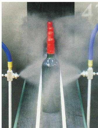
Due atomizzatori modello EB1040SS sono utilizzati per risciacquare bottiglie di vino
