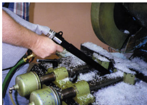
Kit Collection System 6192 aspira polvere di plastica
