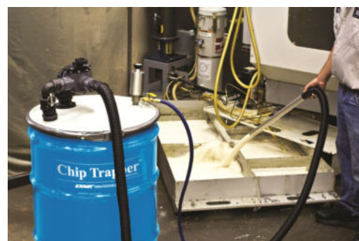
Emulsione filtrata da Chip Trapper
