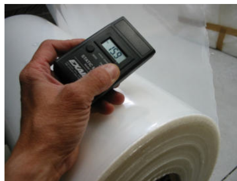
Rilevazione di cariche elettrostatiche su film termoretraibile
