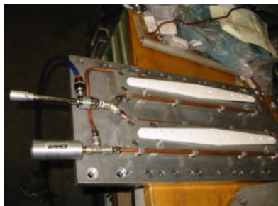
Raffreddamento dopo saldatura ultrasuoni eliche lavastoviglie
