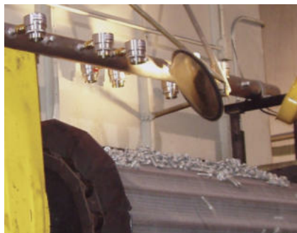
Amplificatori cod 6042 asciugano pezzi dopo il lavaggio
