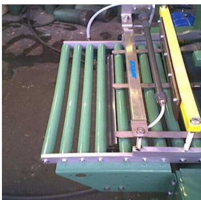
Asciugatura piastrelle in uscita dalla macchina
