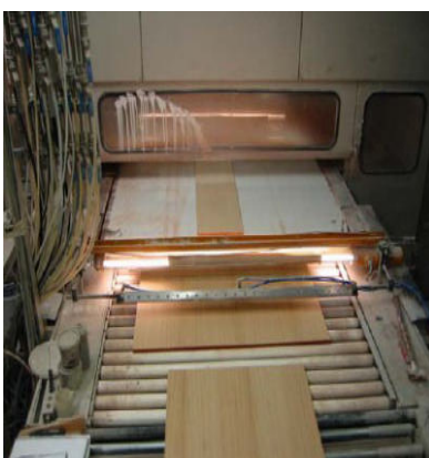
Pulizia pannelli di legno prima della verniciatura
