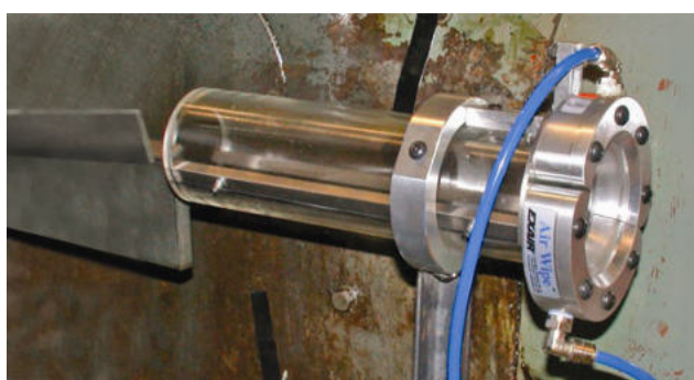
Standard Air Wipe pulisce dal liquido e residui di lavorazione pezzi che passano attraverso il dispositivo
