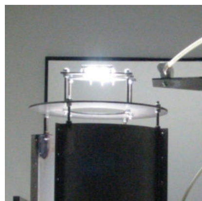
Raffreddamento lampada e filtro per simulatore solare
