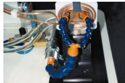
Raffreddamento trafilatura per produrre tubetti uso medicale
