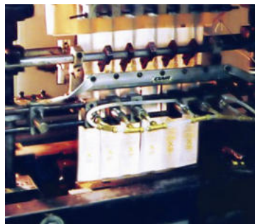
Standard air Knife apre sacchetti per confezionamento
