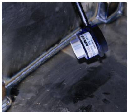
Raffreddamento di cordoni di saldatura
