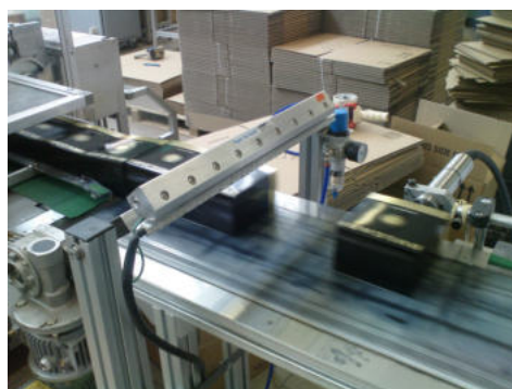
Gen4 Super Ion Air Knife codice 112018 neutralizza confezioni di cartone
