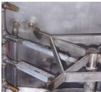
Asciugatura pezzi all'interno di una lavatrice industriale
