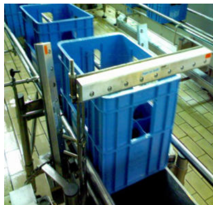
Asciugatura cassette di plastica per acqua minerale
