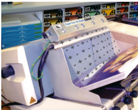
Gen4 Super Ion Air Knife 112009 neutralizza la carica prima della stampa ink jet
