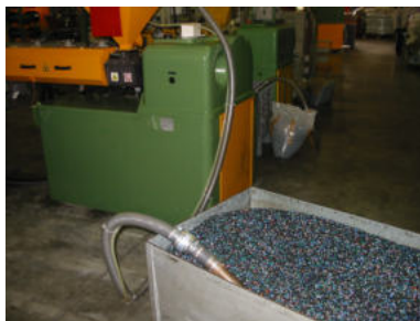
Line Vac codice 6082 trasporta oltre 10 Kg/min di granuli
