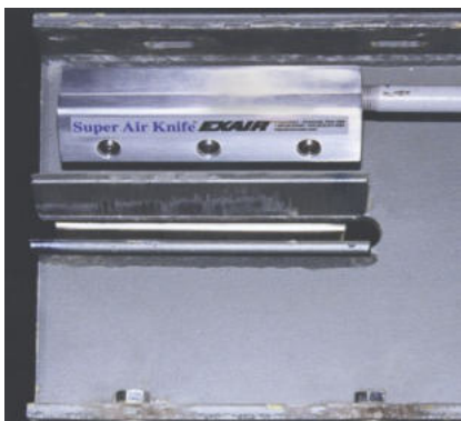
Raffreddamento motore lineare in una applicazione estremamente gravosa
