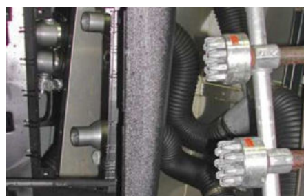
Ugelli Super Air Nozzles Cluster forza sviluppata oltre 4,4 chili!
