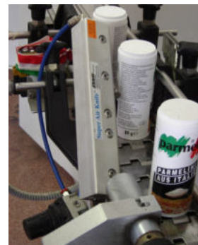
Pulizia contenitori per alimenti prima dell'etichettatura
