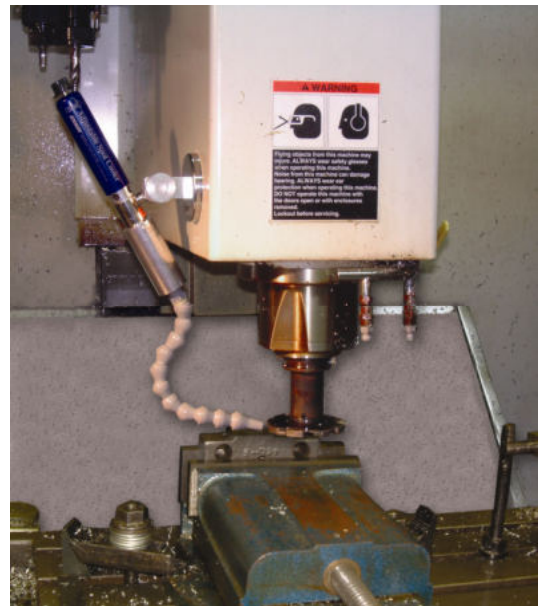
Raffreddamento in fresatura
