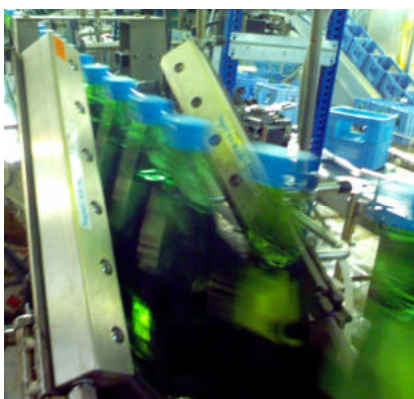
Asciugatura bottiglie in vetro prima dell'etichettatura
