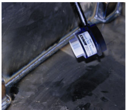
Raffreddamento di cordoni di saldatura
