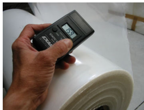
Rilevazione di cariche elettrostatiche su film termoretraibile
