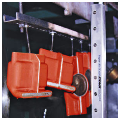
Raffreddamento pezzi rivestiti di plastica
