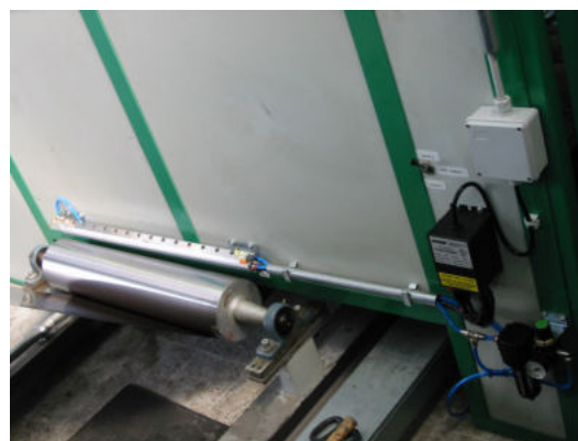
Gen4 Standard Ion Air Knife neutralizza cariche e pulisce film di lamiera metallica
