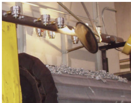
Amplificatori cod 6042 asciugano pezzi dopo il lavaggio
