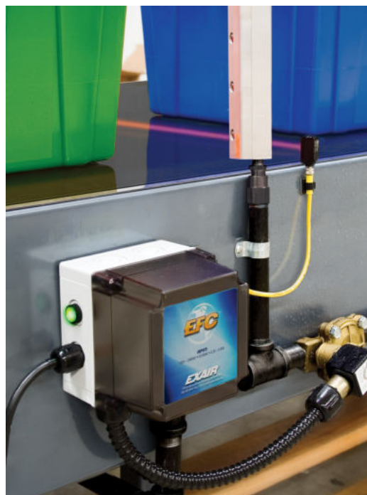
Controllo Elettronico di Flusso EFC installato su impianto
