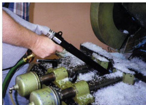
Kit Collection System 6192 aspira polvere di plastica
