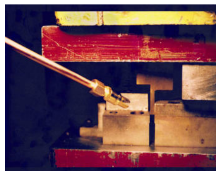
Ugello Safety Air Nozzle 1002 diminuisce il rimbalzo dei trucioli verso l'operatore
