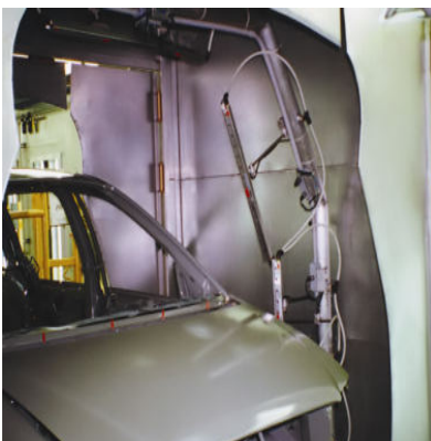
Pulizia carrozzerie di automobili prima della verniciatura
