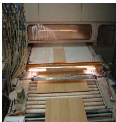
Pulizia pannelli di legno prima della verniciatura
