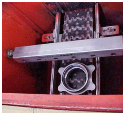
Pulizia pezzi durante il ciclo di lavorazione
