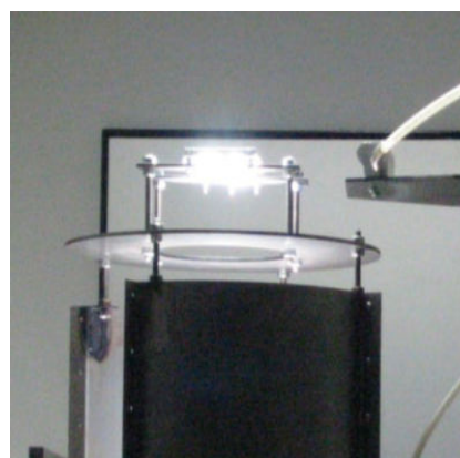
Raffreddamento lampada e filtro per simulatore solare
