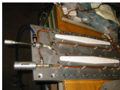
Raffreddamento dopo saldatura ultrasuoni eliche lavastoviglie
