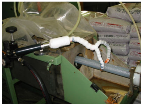
Raffreddamento di tubi dopo l'estrusione
