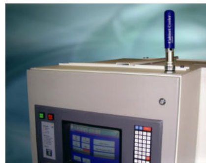
Condizionatore Exair 4015 su pulsantiera di comando CNC
