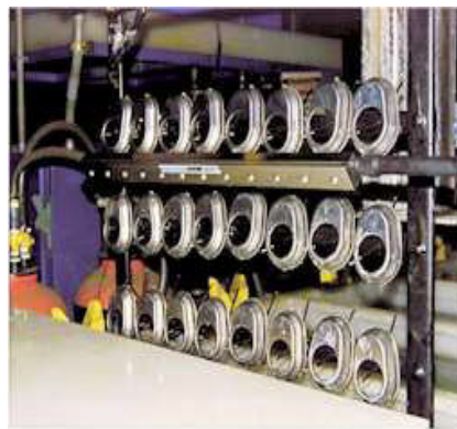
Asciugatura pezzi dopo il lavaggio e sgrassaggio
