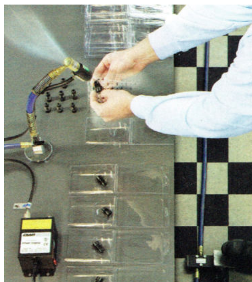
Stay Set Gen4 Ion Air Jet codici 8194-9362 rimuove la polvere da componenti prima del confezionamento in blister
