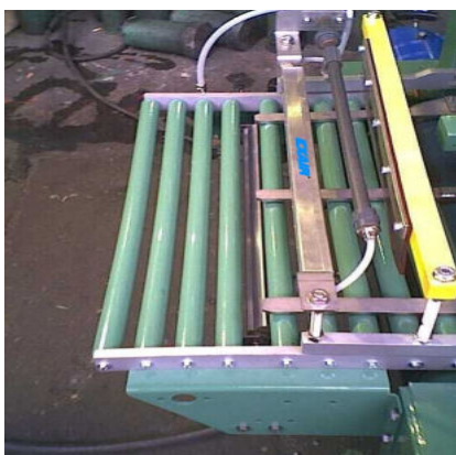
Asciugatura piastrelle in uscita dalla macchina
