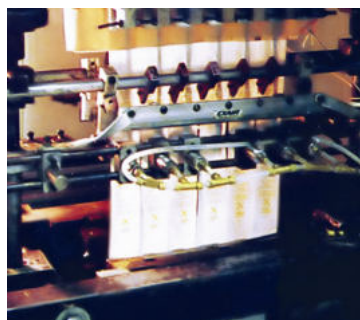
Standard air Knife apre sacchetti per confezionamento
