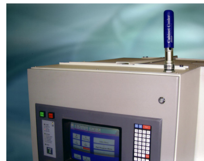
Condizionatore Exair 4015 su pulsantiera di comando CNC
