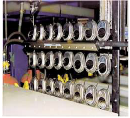
Asciugatura pezzi dopo il lavaggio e sgrassaggio
