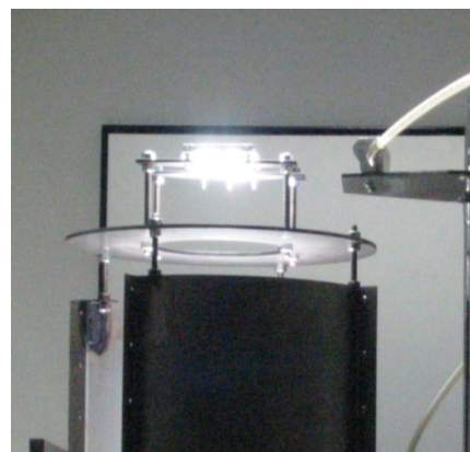
Raffreddamento lampada e filtro per simulatore solare
