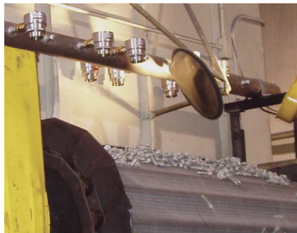
Amplificatori cod 6042 asciugano pezzi dopo il lavaggio
