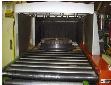
Alcuni amplificatori cod 6041 puliscono e raffreddano pezzi in ghisa dopo la lavorazione
