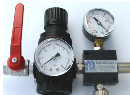
Il manometro pressione acqua ed il vuotometro, quest'ultimo se indica un valore superiore a 0,5/0,6 BAR il miscelatore sta funzionamento
