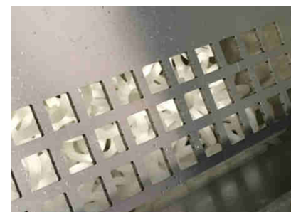
Anelli di separazione olio-emulsione
