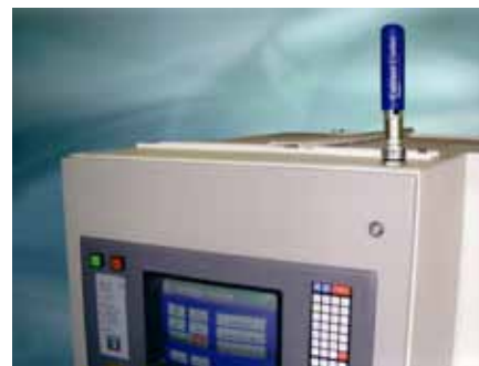
Condizionatore Exair 4015 su pulsantiera di comando CNC
