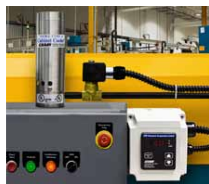
Controllo elettronico della temperatura ETC codice 9239
