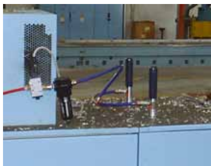
Condizionatori Exair 4030 su quadro elettrico di un'alesatrice
