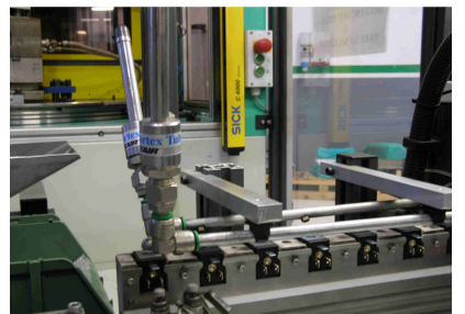
Raffreddamento di bobine per elettrovalvole dopo la saldatura
