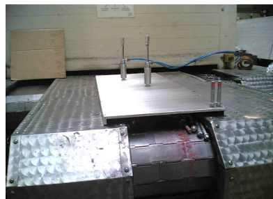
Raffreddamento di bulloni dopo l'applicazione del freno filetti
